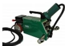
Сварочный аппарат горячего воздуха для сварки кровельных покрытий Dohle RoofOn Digital (Доле РуфОн Диджитал) предназначен для сварки без складок полимерных кровельных покрытий внахлест (ПВХ-мембраны, ТПО и пр.) максимальной толщиной 1,5 мм с шириной сварного шва 40 мм. Надежный и неприхотливый автомат идеально подходит для небольших объемов работ и как вспомогательный аппарат на больших объектах, а также в местах, где запрещена работа открытым пламенем.
