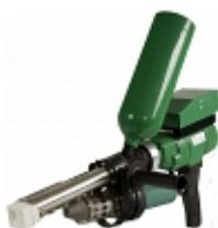
Высокопроизводительный ручной шнековый сварочный экструдер Dohle 6007 CS (Доле 6007 ЦС) со встроенной подачей воздуха предназначен для мобильной экструзионной сварки тостостенных полимерных изделий (толстые полимерные листы), монтажа и ремонта полимерных (полипропиленовых и полиэтиленовых) труб и фитингов, трубопроводов с ППУ-изоляцией и гидроизоляцией, подземных коллекторов, полимерных гидроизолирующих покрытий, геомембран с использованием, в качестве присадочного материала, гранул.
